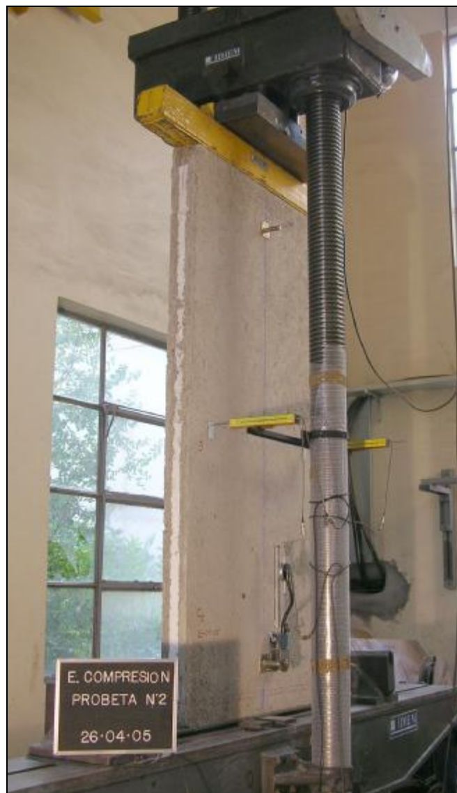
Foto 6. Vista general del montaje del ensayo de compresión.
