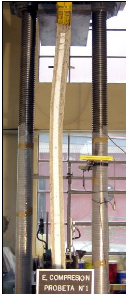
Foto 7. Falla del panel N°1 por pandeo general (ensayo de compresión).
