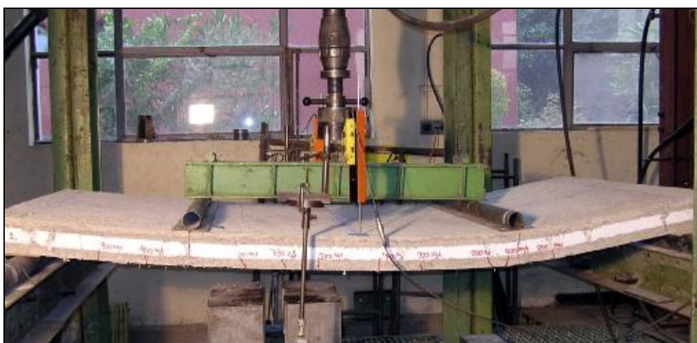
Foto 3. Modo de falla del panel N°2 (ensayo de flexión).
