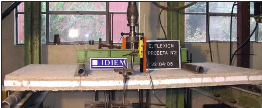
Foto 1. Vista general del montaje del ensayo de flexión.
