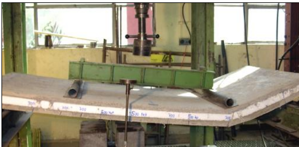
Foto 2. Modo de falla del panel N°1 (ensayo de flexión).
