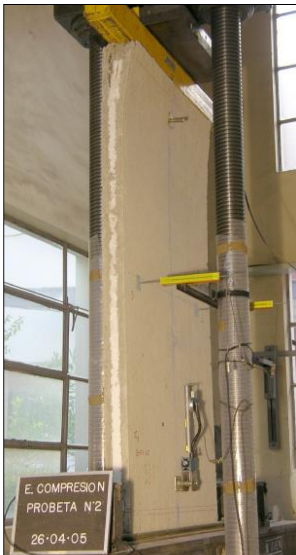
Foto 8. Falla del panel N°2 por pandeo en el cuarto superior (ensayo de compresión).
