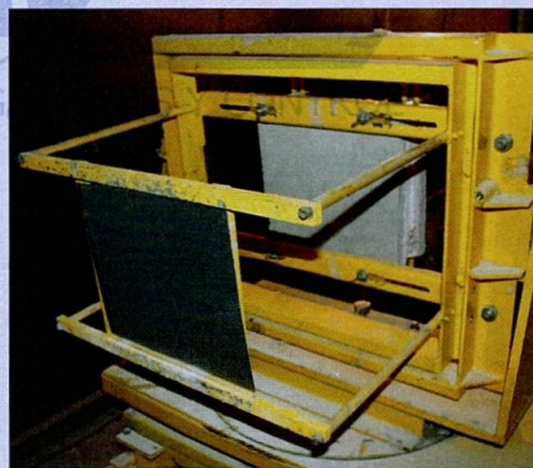
Vista posterior del panel de concreto, disparado con 9x19mm nivel II NIJ 0108.01. Luego del ensayo Vista posterior
