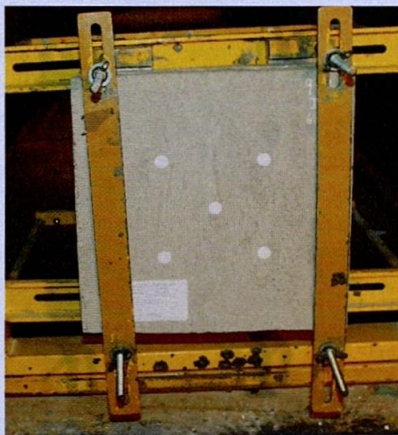
Vista frontal del panel de concreto, disparado con 9x19mm nivel II NIJ 0108.01. Antes del ensayo Vista frontal
