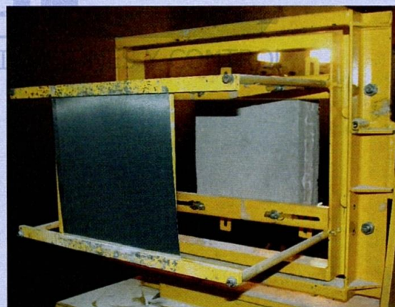
Vista posterior del panel estructural, disparado con .357Mag nivel II NIJ 0108.01. Luego del ensayo Vista posterior
