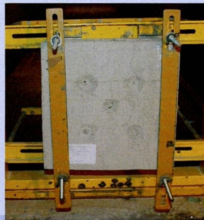
Vista posterior del material testigo, disparado con 9x19mm nivel II NIJ 0108.01. Luego del ensayo Vista posterior
