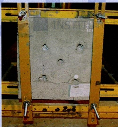
Vista frontal del panel estructural, disparado con .357Mag nivel II NIJ 0108.01. Luego del ensayo Vista posterior
