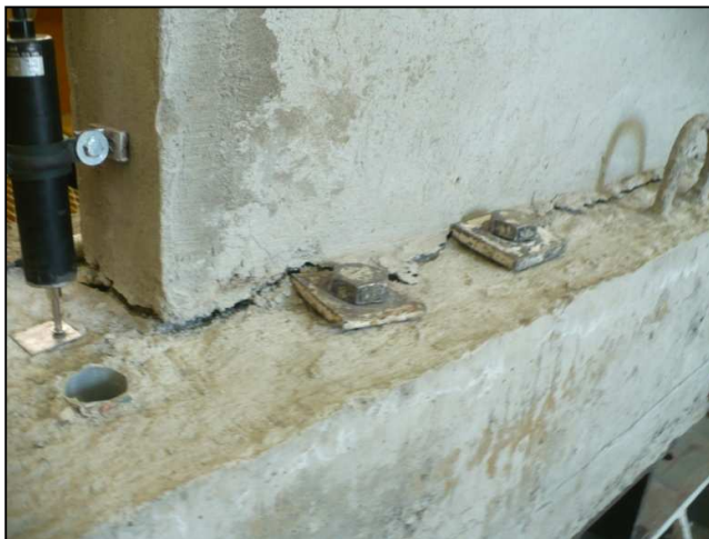
Fotos 11 y 12. Modo de falla de la muestra N° 2.
