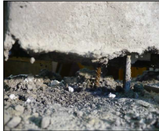
Fotos 9 y 10. Modo de falla de la muestra N° 1.
