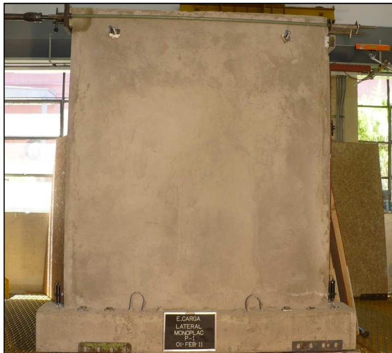
Foto 8. Vista general del montaje del ensayo de carga horizontal al panel.
