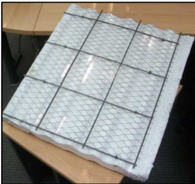
Fotos 1, 2 y 3. Estructura interna de panel Monoplac "PMO-70".
